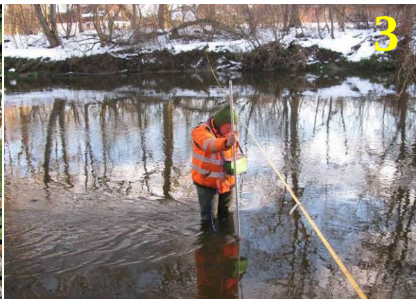
איור 22: (1,2) מיקום המדידות לאורך נחל Wertach בסמוך לכפר Pforzen (מקור: Google Earth, 13.1.2011); (3) חתך הרוחב ו- Peter Krueger בזמן המדידות עם מד זרם אלקטרומגנטי מדגם FlowSense.
